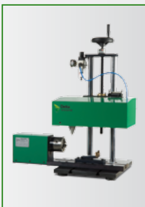
Asse W rotante motorizzato: lunghezza massima pezzo 500mm mandrino autocentrante taglia 80mm
