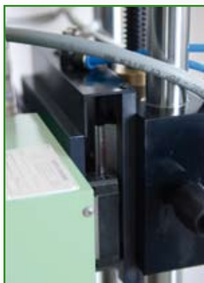
Asse Z pneumatico corsa 25 o 50mm
